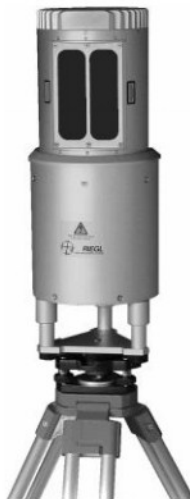
Рис. 7. Сканер RIEGL LMS-Z420
