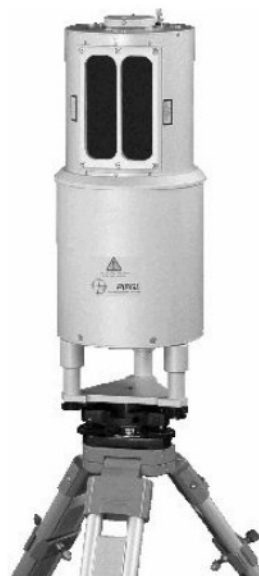
Рис. 5. Сканер RIEGL LMS-Z210
