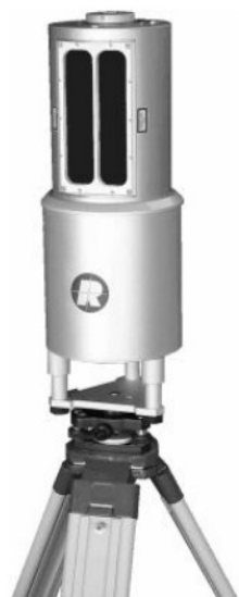
Рис. 6. Сканер RIEGL LMS-Z360
